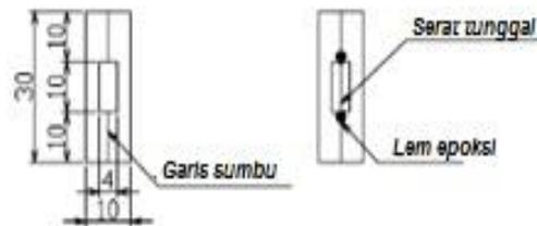
Gambar 2. Spesimen uji tarik serat tunggal
