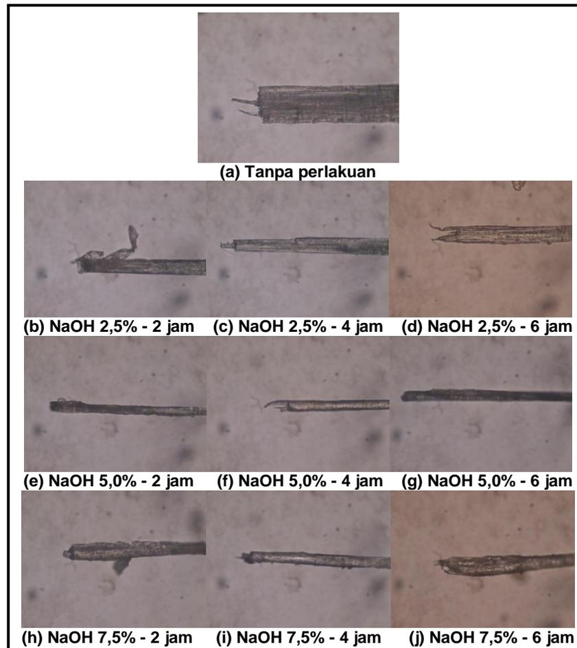
**Gambar 9.** Bentuk Patahan Uji Tarik Serat Mendong Pembesaran 400x
