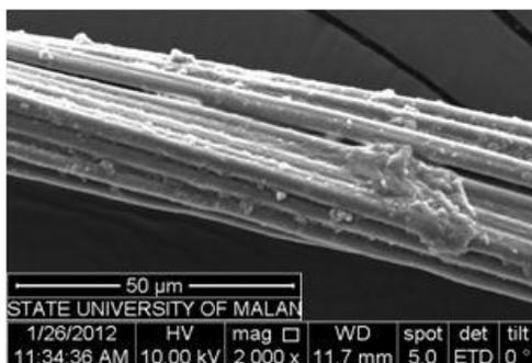
**Gambar 5.** Morfologi Serat Mendong setelah Perlakuan Alkali 2,5% NaOH selama 4 jam, diamati dengan SEM
